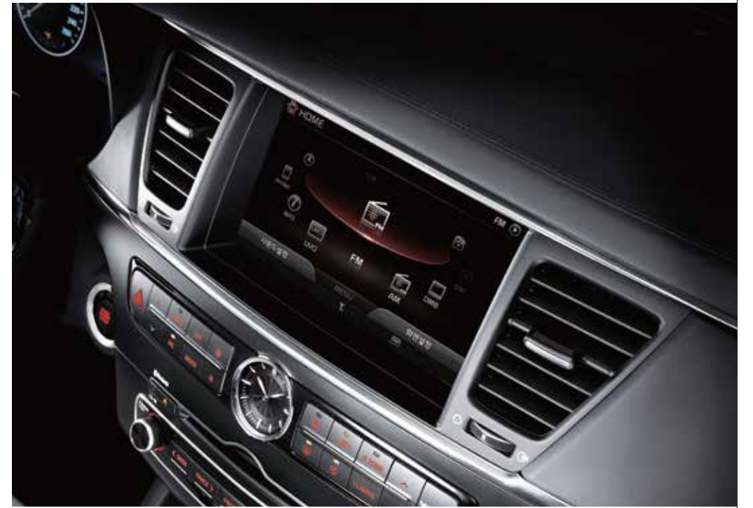
내비게이션 인텔의 ‘차량용 인포테인먼트(in-vehicle infotainment) 시스템’을 탑재한 기아자동차 K9. 앞좌석용 대시보드의 터치스크린과 뒷좌석용 클론 디스플레이 등 두 개의 독립적인 화면으로 구성돼 차량 내 어디서든 원하는 콘텐츠를 바로 즐길 수 있다.
